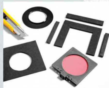
Les pièces de carton sont découpées pour s'adapter à la taille du filtre (ici, Fuji).
