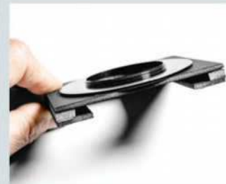
Les pièces sont assemblées avec de l'adhésif double face. Le carton évidé d'un cercle est collé contre la bague.
