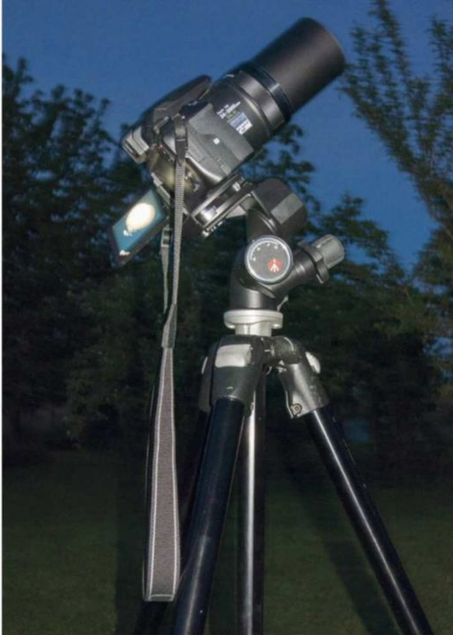
Ci-contre, une photo de l'installation, le Coolpix P900 fixé sur une rotule 3D Manfrotto, elle-même vissée sur la colonne centrale d'un trépied.
