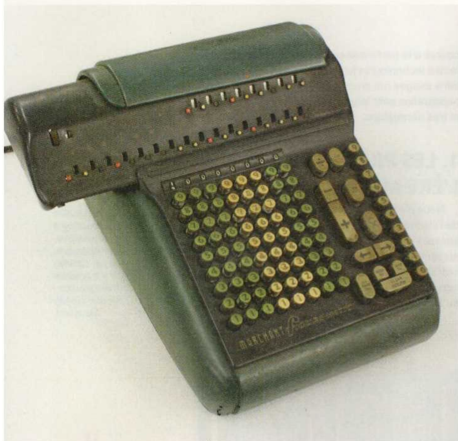
Fig. 2 : Cette machine à calculer « électrique » des années 50 est en fait l'héritière des machines mécaniques de Babbage, mais mue par un moteur électrique. La Marchant Figurematic est utilisée surtout pour la gestion, car incapable de fonctions complexes (ou alors il faut alors combiner des additions et multiplications), et elle est évidemment basée sur le système décimal. Maintenant, imaginez une salle remplie de dizaines de ces machines et leurs opérateurs...
