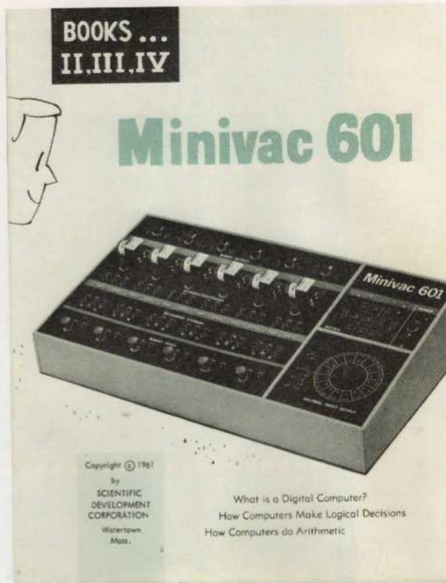
Fig. 4 : Un peu de minimalisme ! Le Minivac 601 n'est pas réellement un ordinateur, mais un kit éducatif fournissant 6 lampes, 6 relais et un bouton rotatif hexadécimal motorisé. Vendu en 1961 pour 85$, la publicité disait que le kit était né d'un projet privé de Claude E. Shannon du MIT (source : Wikipédia).
