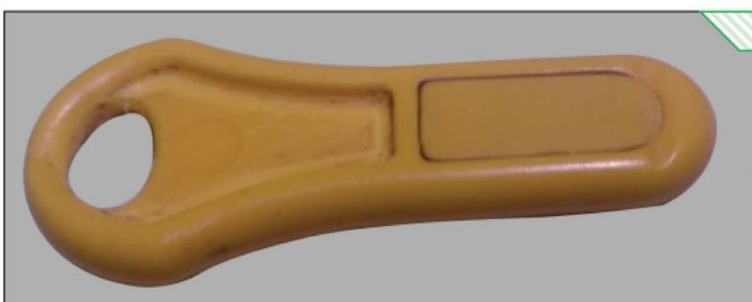
Voici un exemple de clé pour machine à café. Celle-ci fonctionne avec une puce RFID (transpondeur PCF7931AS) du domaine public...
