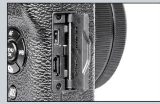
La connectique (USB 2.0 et HDMI) est abritée dans un petit placard sur le flanc droit. De l'autre côté, un bouchon protège une entrée micro.
