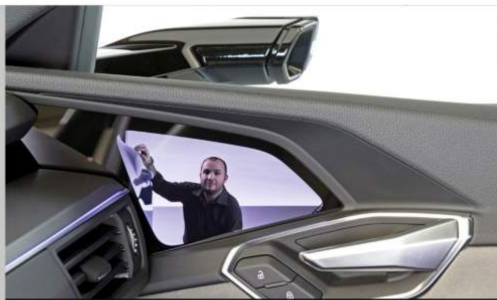
L'e-tron peut disposer, en option, de caméras en guise de rétroviseurs. Les écrans OLED sont sur les contres-portes.
