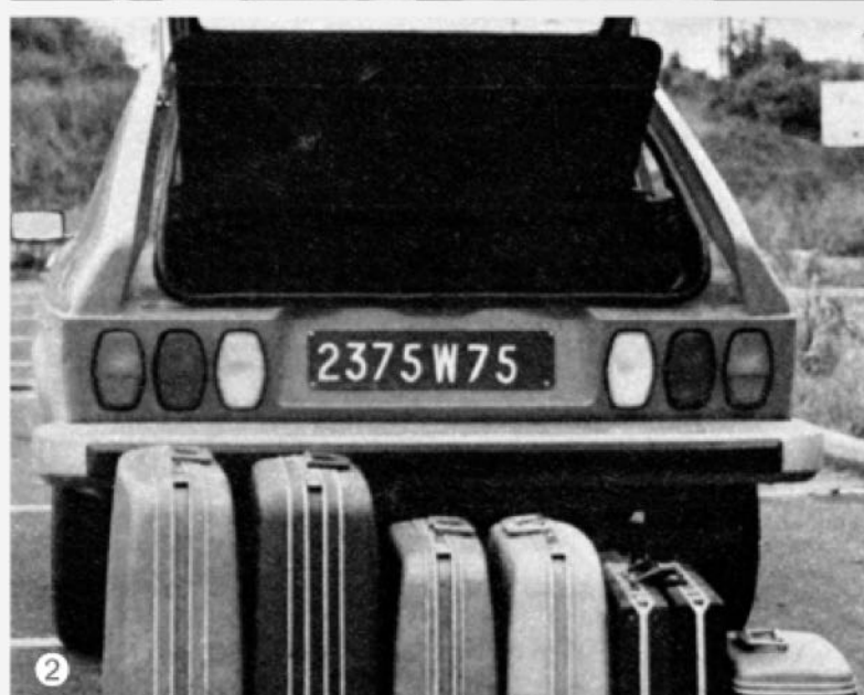
❶ Ce bloc est un brillant 4 cylindres de 1 290 cm 3 à arbre à cames en tête, développant 73 ch DIN à 6 000 tr/mn. ❷ Selon la configuration, le coffre pouvait englober de 271 à 528 dm 3 de bagages.
