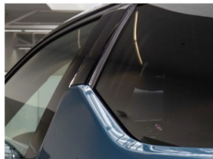
Les designers ont camouflé l'habituel jonc entourant le vitrage en remontant la tôle.
