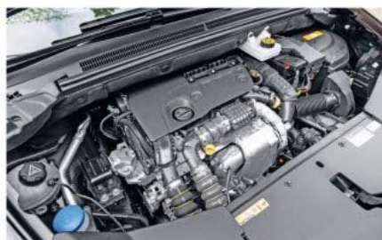
Le 1.6 diesel PSA gagne dans cette nouvelle version BlueHDi 120 un système de traitement des NOx mais délaisse l'alternateur e-HDi.
