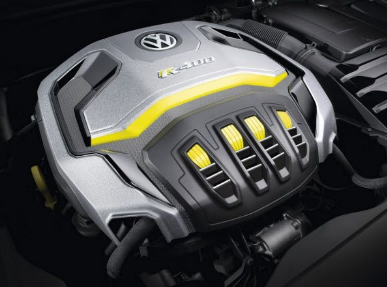
Ce 4 cylindres 2.0 TSI officie déjà sous le capot de la Golf GTI, mais dans ce concept il développe 400 ch.
