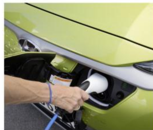
Le Kona dispose d'une fonction (contrôlée par le propriétaire) qui permet à un tiers de le débrancher une fois la charge terminée.
