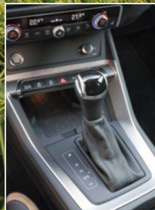
La boîte S tronic fait de la sobriété son objectif. Résultat, elle passe à la hâte les rapports supérieurs et manque de réactivité en rétrogradage.
