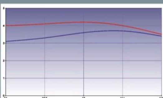
**35 mm:** Le piqué reste schématiquement au même niveau qu'à 24 mm même si on note une amélioration du micro-contraste à pleine ouverture sur les bords. La distorsion est imperceptible (léger bâillet) mais le vignetage reste visible (1 IL à f:4). L'aberration chromatique est très bonne (0,3 %).
