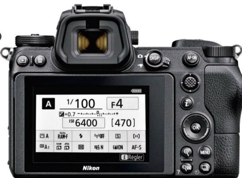
Le large écran tactile ne pilote pas le collimateur AF lorsque l'œil est au viseur. C'est le petit joystick qui s'en charge avec réactivité.
