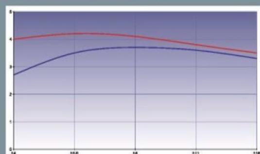
**24 mm:** Les performances sont excellentes dès f:4 et le restent jusqu'à f:11. Sur les bords, le contraste manque à f:4 mais progresse rapidement. La distorsion est faible (-1,5 % en bâillet) et le vignetage est marqué » (2 IL à f:4). L'aberration chromatique est en revanche maîtrisée (0,2 %).
