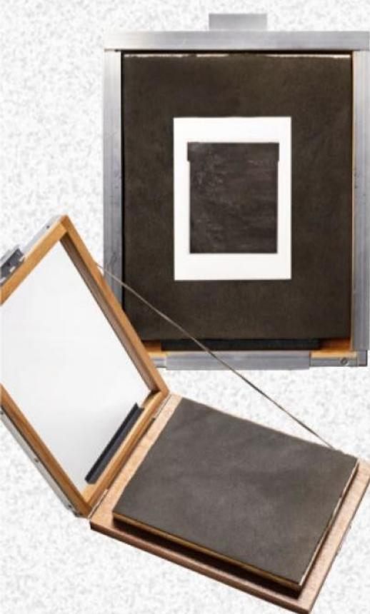
Pour obtenir une définition optimale, le négatif doit être parfaitement pressé contre le papier. Cette contacteuse réalisée sur mesure offre une forte pression du verre sur le négatif.
