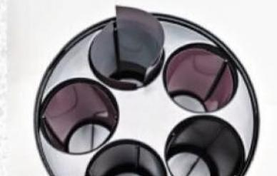
**Les films sont insérés dans les orifices du tambour en les incurvant. La cuve 3010 permet d'insérer deux plans-films 4x5 par orifice. Dans la cuve 3005, un plan-film par orifice.**
