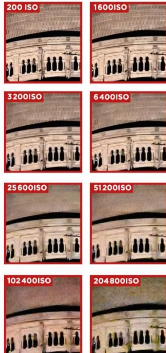
L'association d'une stabilisation mécanique performante et d'un bon comportement dans les hautes sensibilités font du Z6 un oiseau de nuit efficace. Il faut dépasser 6400 ISO pour voir le lissage grignoter significativement les plus fins détails.
