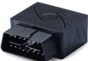
Si vous nous lisez depuis longtemps vous connaissez les prises OBDII (ou OBD2) qui sont utilisées dans les automobiles pour brancher des sondes électroniques ou des ordinateurs et contrôler ou corriger tout un tas de choses. Cette prise est souvent bien cachée sous le tableau de bord ou au fond de la boîte à gants : il existe même des personnes qui n'ont même pas idée qu'une telle prise existe. C'est donc une idée de
