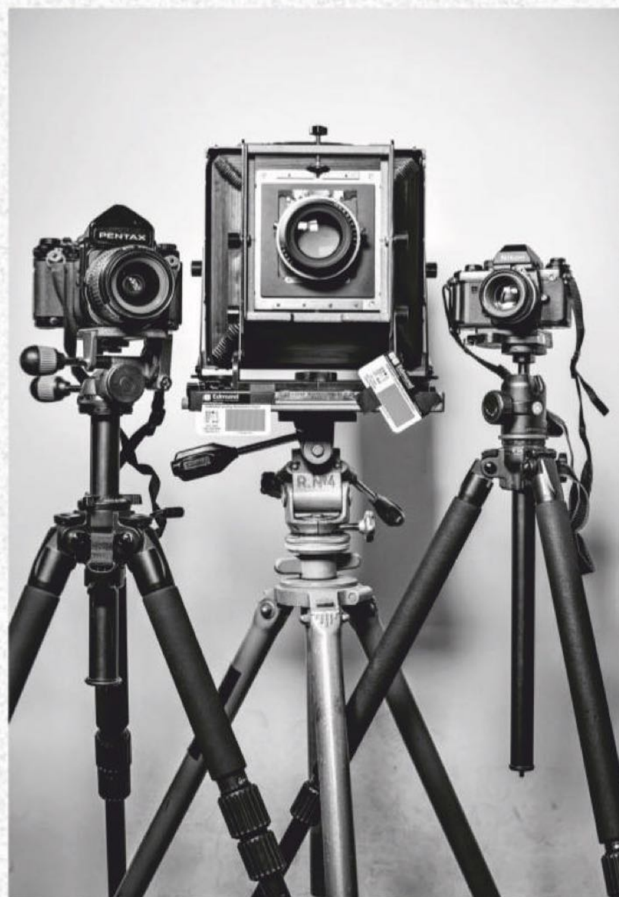
La scène de référence présente trois formats d'appareils : 24x36 (Nikon), 6x7 (Pentax 67) et 8x10 pouces (Kodak Master Camera). Deux chartes Edmund Optics USAF sont placées sur la chambre, à l'horizontale et en diagonale, pour comparer la définition des tirages argentiques et jet d'encre.
