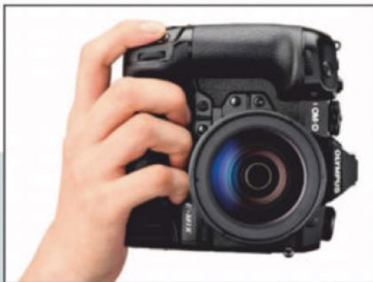
Les commandes importantes sont reportées en position verticale, comme le joystick autofocus.
