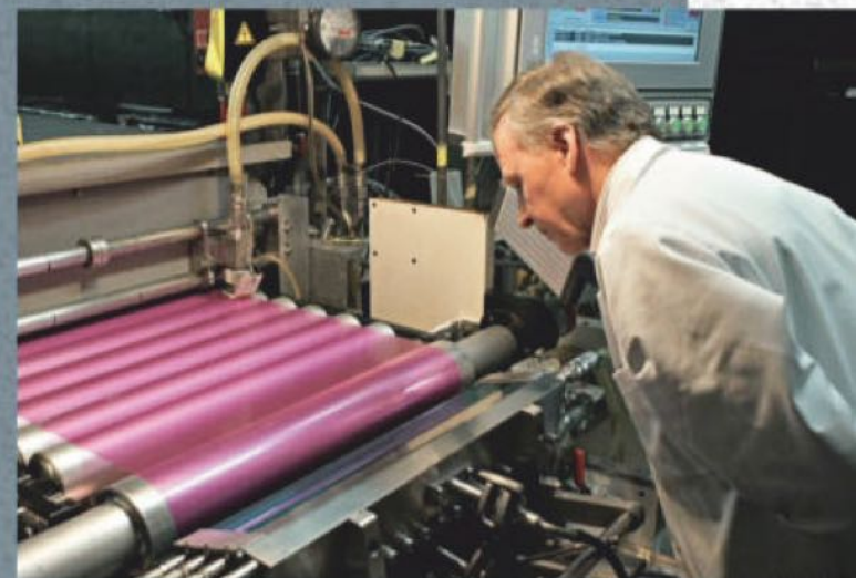
Meinrad Schär, ancien chimiste chez Ilford ayant repris du service pour Adox, inspecte la tête de coulage de la machine d'enduction d'Ilford avant le couchage de l'émulsion.
