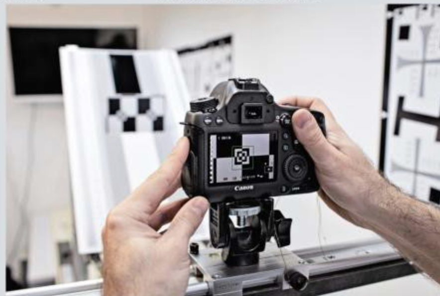
Sur ce pied, on réalise un test pour vérifier qu'il n'y a pas de back ou de front focus, soit un décalage de la mise au point.
