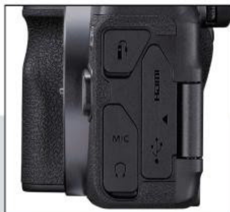
Les connectiques sont complètes, avec notamment les entrées et sorties audio.
