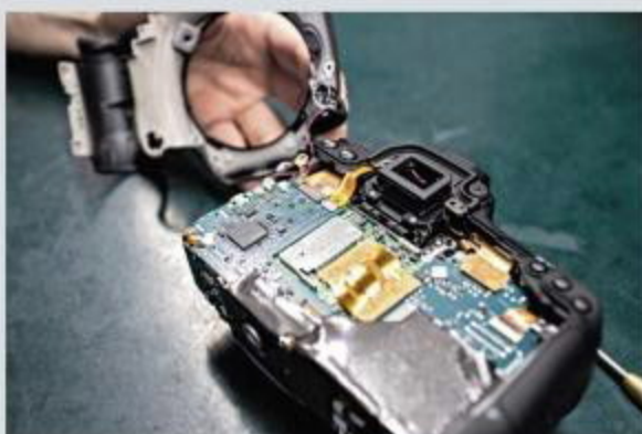
Les circuits sont complexes, et il faut être vigilant lors du démontage pour ne rien arracher.
