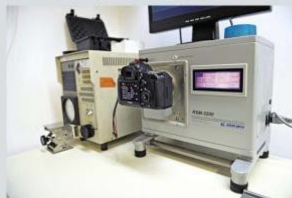
Une fois remonté, le boîtier subit une batterie de tests comme ici le tirage mécanique.
