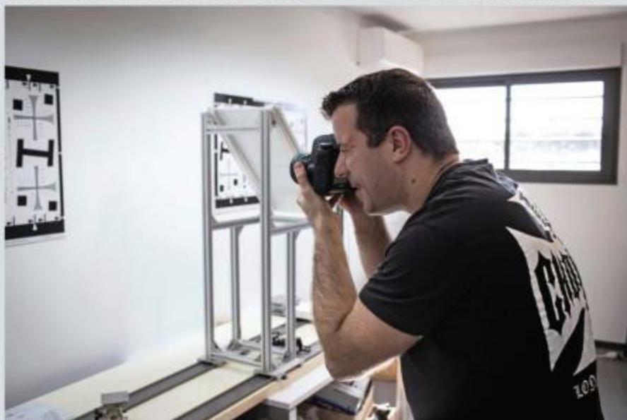
Dans une salle à part, les réparateurs vérifient et règlent le matériel. En visant une mire, Nicolas s'assure que l'autofocus est correctement paramétré.
