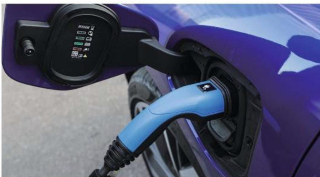
**Sur une wallbox (7 kW), la charge prend une nuit contre environ 1 h30 sur une borne 100 kW. Le I-Pace ne peut pas être branché sur les superchargeurs Tesla (150 kW).**
