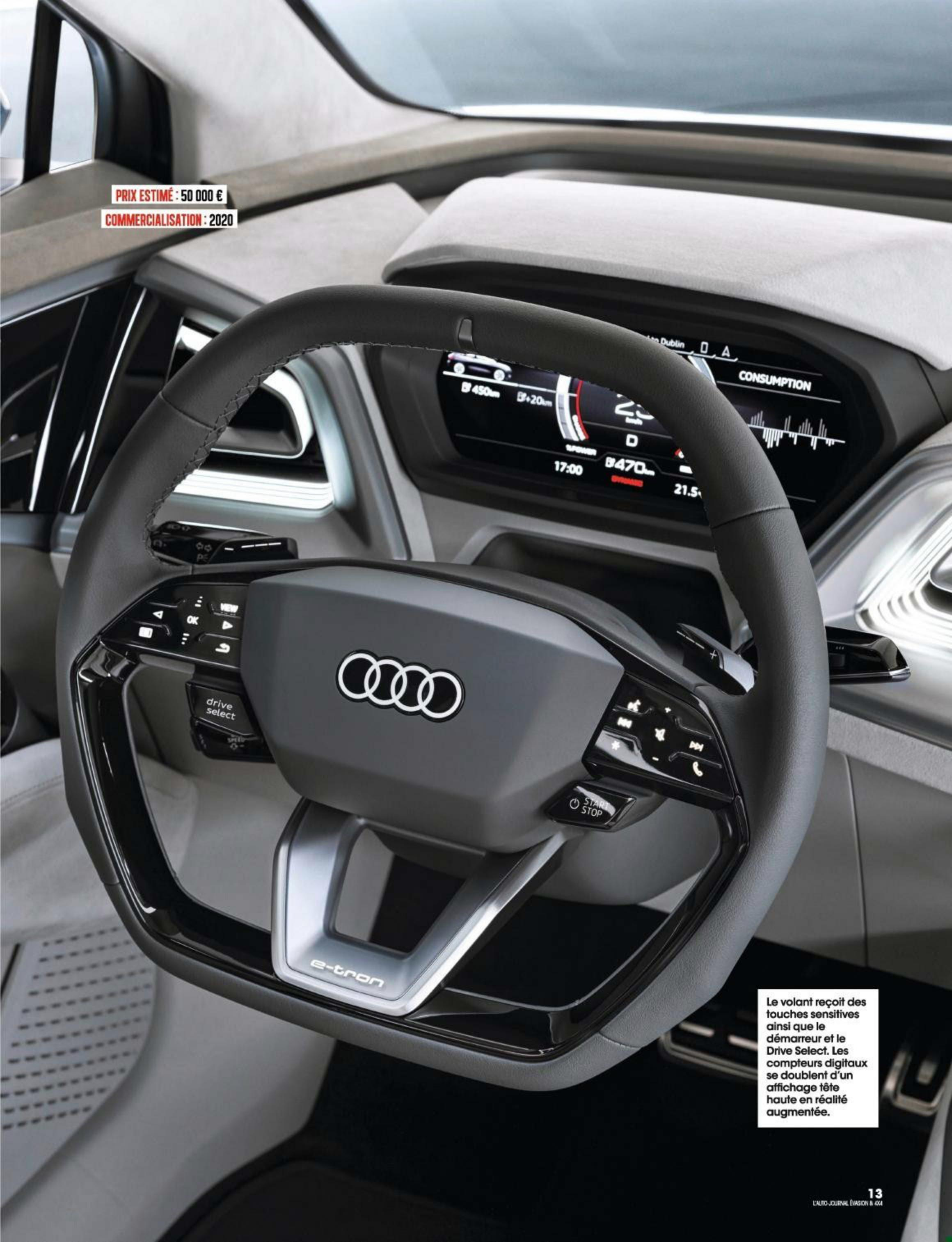
Le volant reçoit des touches sensitives ainsi que le démarreur et le Drive Select. Les compteurs digitaux se doublent d'un affichage tête haute en réalité augmentée.
