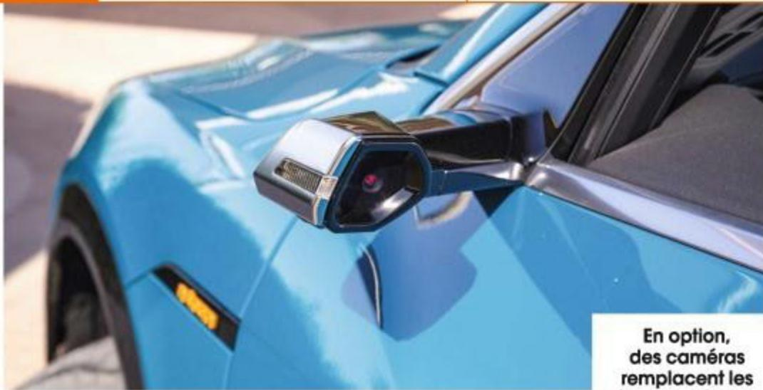
En option, des caméras remplacent les rétros. Les écrans, implantés bas, demandent un temps d'adaptation.
