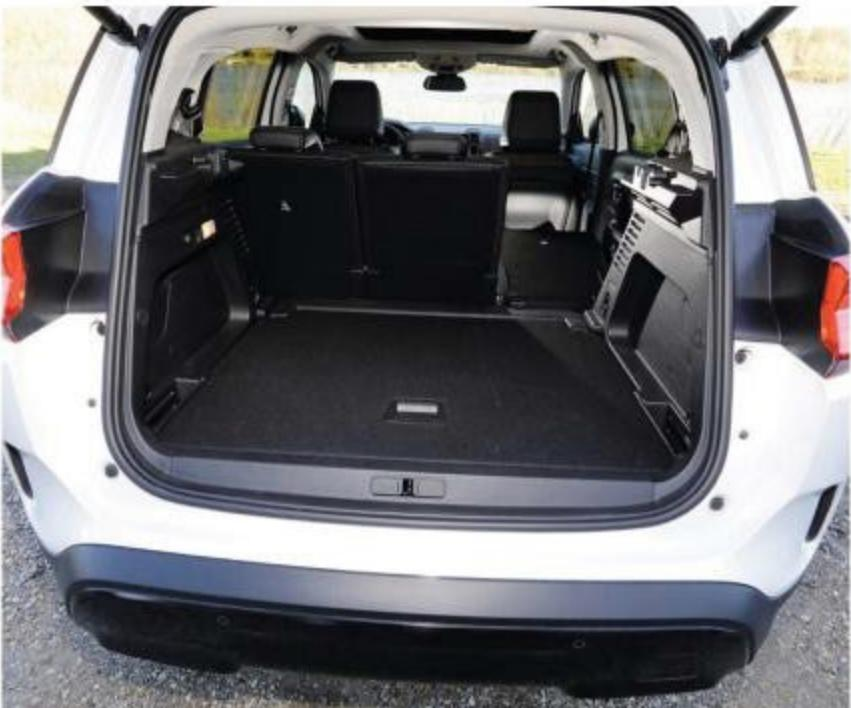
Disposant d'un volume généreux (615 dm<sup>3</sup>), le coffre offre une excellente modularité grâce aux sièges qui coulissent sur 14 cm.
