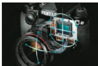
Stabilisation 5 axes du capteur
