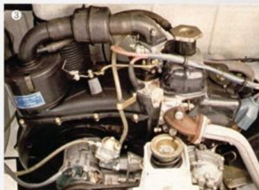
❶ Le moteur, toujours situé à l'arrière, bénéficie enfin d'un capot fermant à clé. ❷ Le bouchon de réservoir gagne une serrure. ❸ À l'instar de la vénérable 500, la 126 reçoit à l'arrière un bicylindre refroidi par air. C'est un 652 cm 3 développant 24 ch DIN à 4 500 tr/mn ! ❹ Le petit coffre avant est encombré par les passages de roues et la roue de secours.
