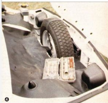
❶ Le moteur, toujours situé à l'arrière, bénéficie enfin d'un capot fermant à clé. ❷ Le bouchon de réservoir gagne une serrure. ❸ À l'instar de la vénérable 500, la 126 reçoit à l'arrière un bicylindre refroidi par air. C'est un 652 cm 3 développant 24 ch DIN à 4 500 tr/mn ! ❹ Le petit coffre avant est encombré par les passages de roues et la roue de secours.
