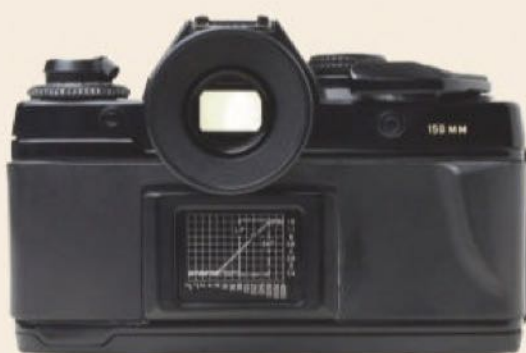
Vu de dos, de gauche à droite, verrou des vitesses, œillette de viseur, prise de télédéclenchement. Le dos à charnière, dégonflable, porte un tableau synoptique des modes P.
