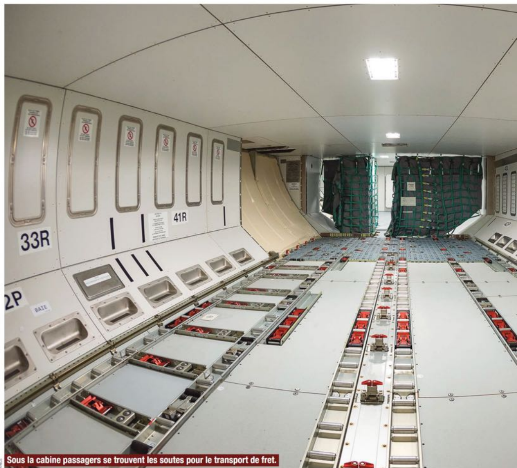
Sous la cabine passagers se trouvent les soutes pour le transport de fret.
