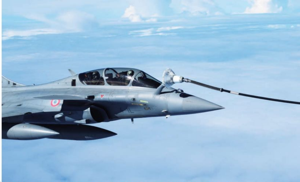
Un Rafale au ravitaillement sur le système souple déployé depuis les nacelles se trouvant en bout d'ailes.
