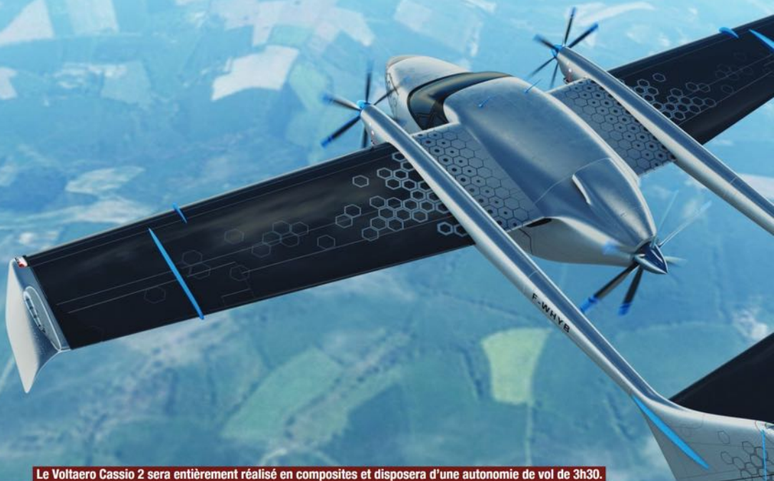
Le VoltAero Cassio 2 sera entièrement réalisé en composites et disposera d'une autonomie de vol de 3h30.
