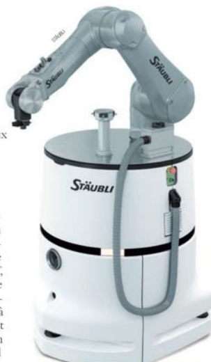
HelMo, robot mobile autonome, couplé à un bras robotisé collaboratif TX-2.
