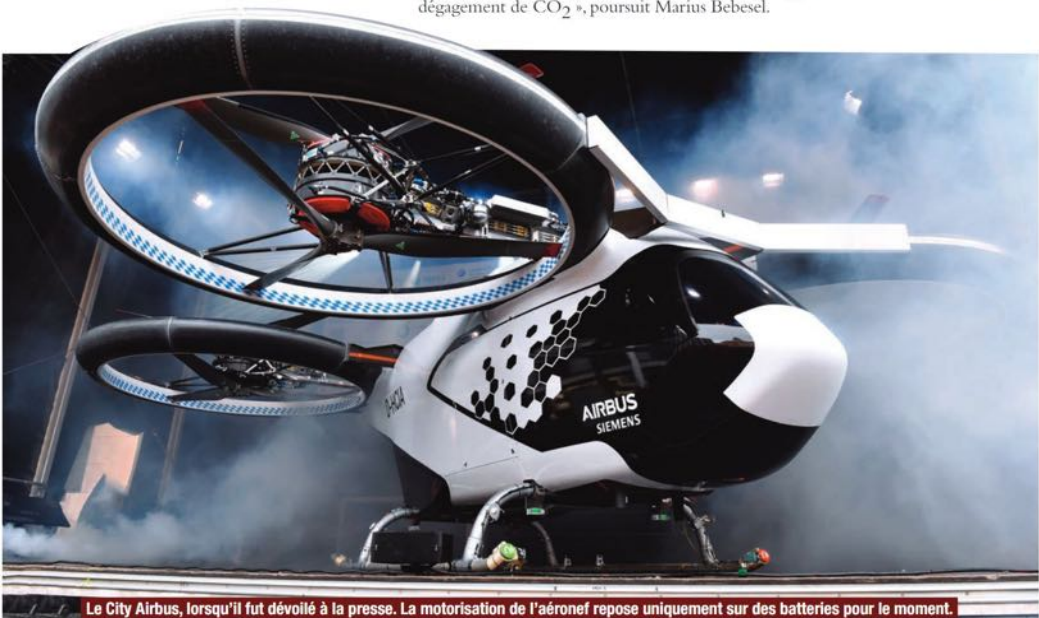
Le City Airbus, lorsqu'il fut dévoilé à la presse. La motorisation de l'aéronef repose uniquement sur des batteries pour le moment.
