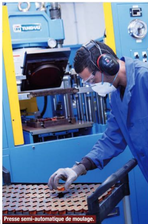
Presse semi-automatique de moulage.
