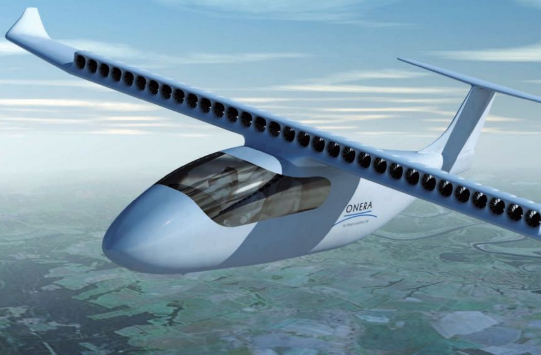
La propulsion distribuée a fait l'objet de l'étude d'un premier concept, Ampere, au sein de l'Onera, qui a été soufflé à Lille.
