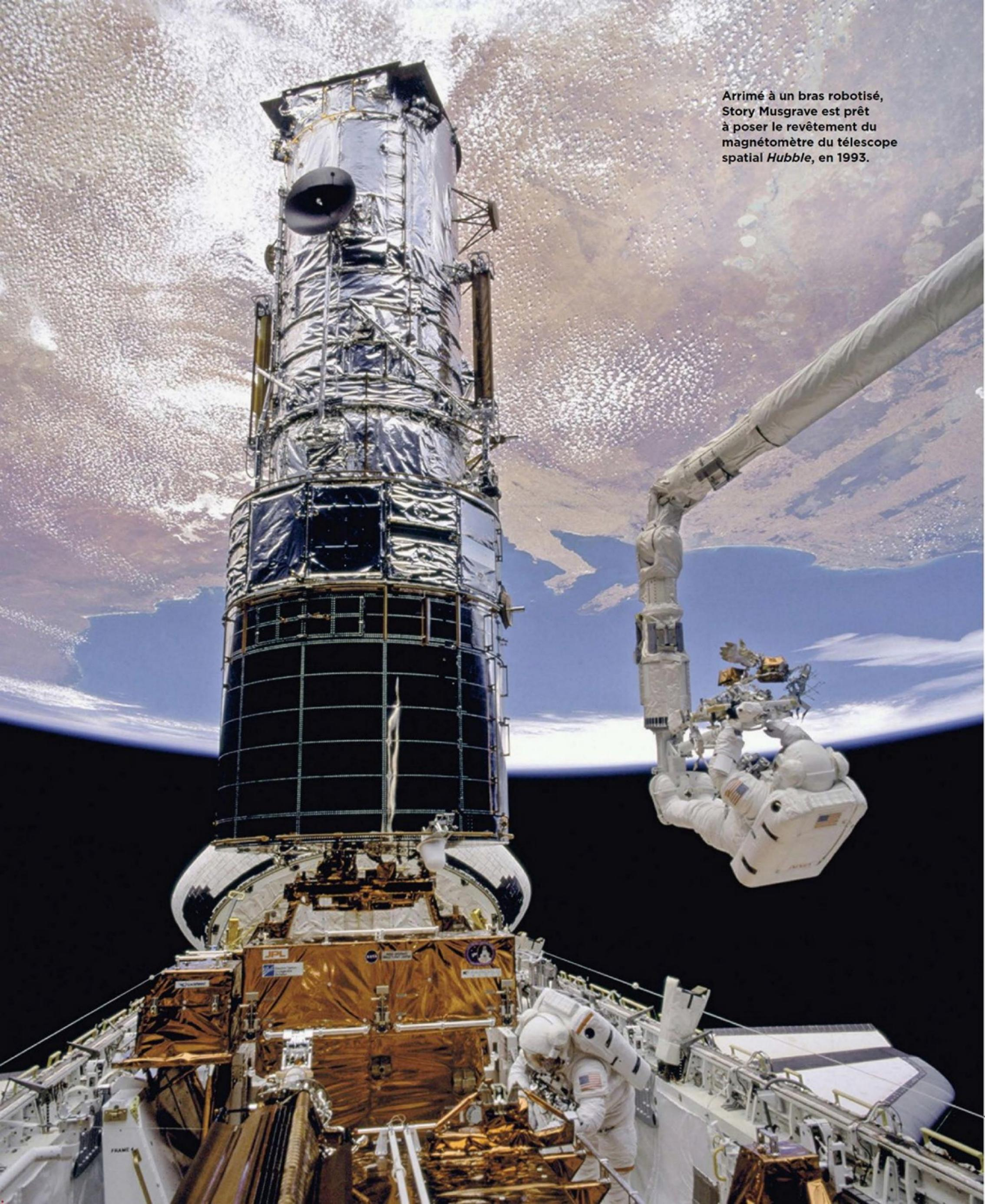
Arrimé à un bras robotisé, Story Musgrave est prêt à poser le revêtement du magnétomètre du télescope spatial *Hubble*, en 1993.
