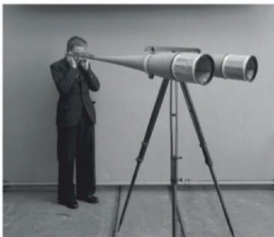
(2) Cornets acoustiques pour le repérage des avions de Georges Mabboux, 31 mai 1935. Collection CNRS
