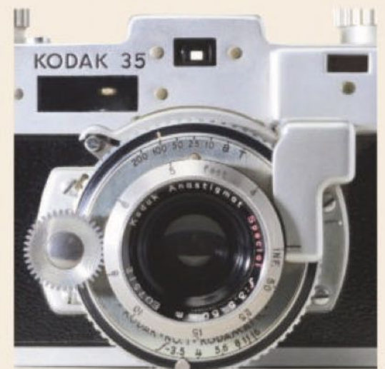
Vue de face en gros plan : de part et d'autre de la frontale, molette de mise au point et capotage dissimulant (?) la tringlerie du télémetre.
