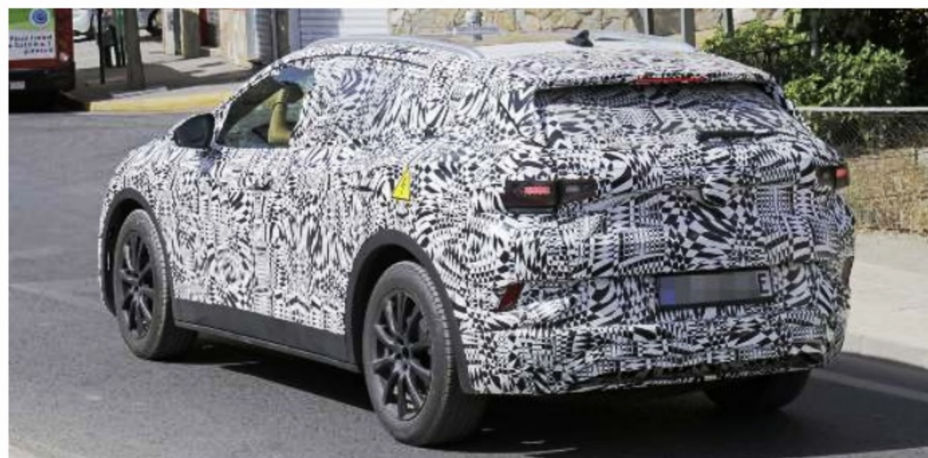
Le SUV Volkswagen devrait transmettre aux roues arrière les 170 ch de son électromoteur. Trois capacités de batteries au programme.
