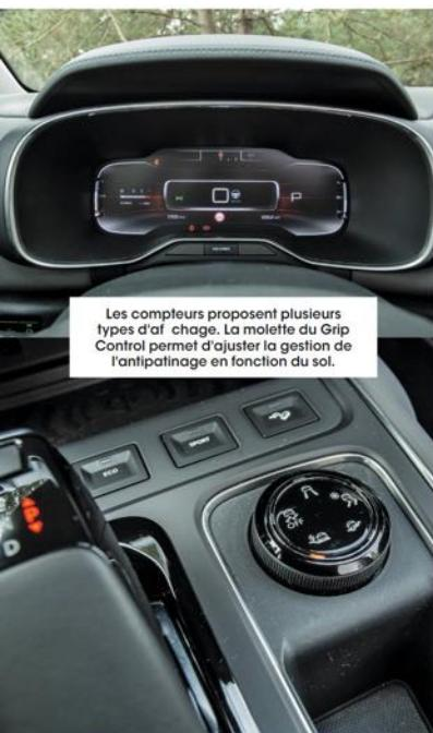
Les compteurs proposent plusieurs types d'affichage. La molette du Grip Control permet d'ajuster la gestion de l'antipatinage en fonction du sol.
