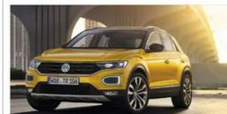
Lancé en 2017, le T-Roc se positionne entre un 2008 et un 3008. Il repose sur un châssis de Golf et en reprend bon nombre d'équipements. L/I/h/e (m) : 4.23 / 1.82 / 1.54 / 2.59 - 5 places
