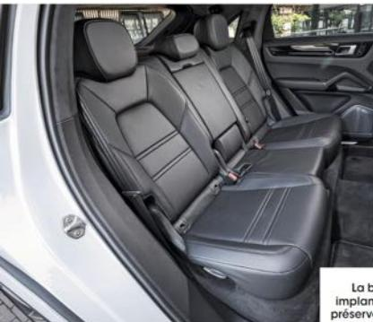
La banquette implantée plus bas préserve la garde au toit des passagers arrière. Le coffre perd quelques dm<sup>3</sup> mais il en reste encore 625.
