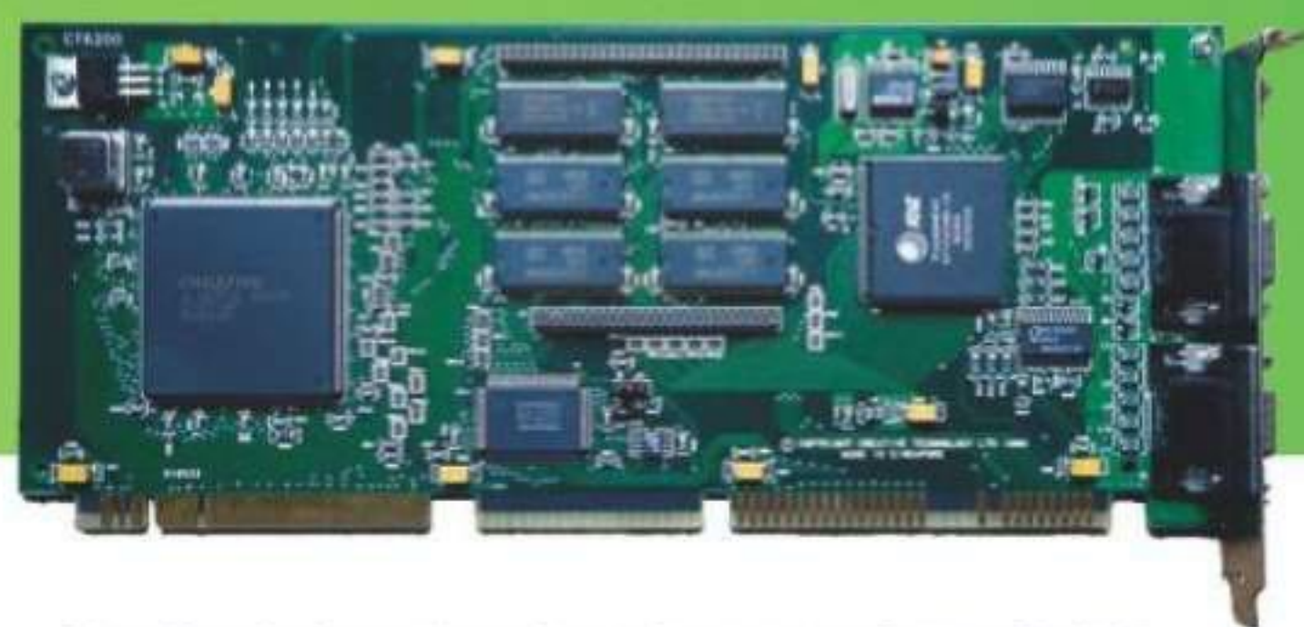
Creative Labs a donné sa chance au Game GLINT de 3Dlabs via cette imposante carte VLB, mais la marque s'est rapidement tournée du côté de Rendition pour ses cartes PCI.
