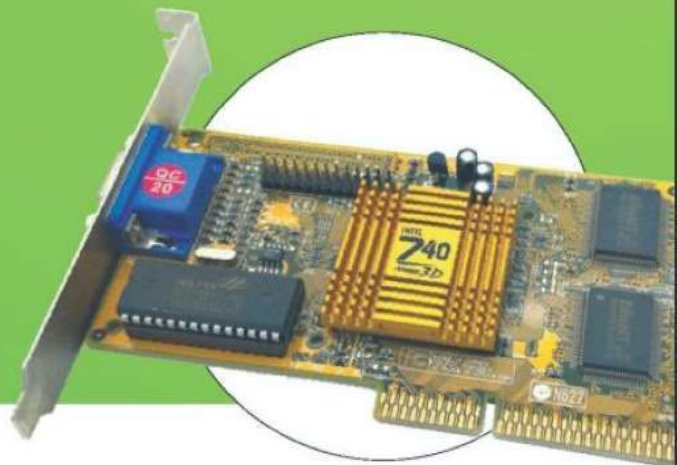
Grâce à l'AGP texturing, l'Intel 740 pouvait être intégré sur des cartes très bon marché.
