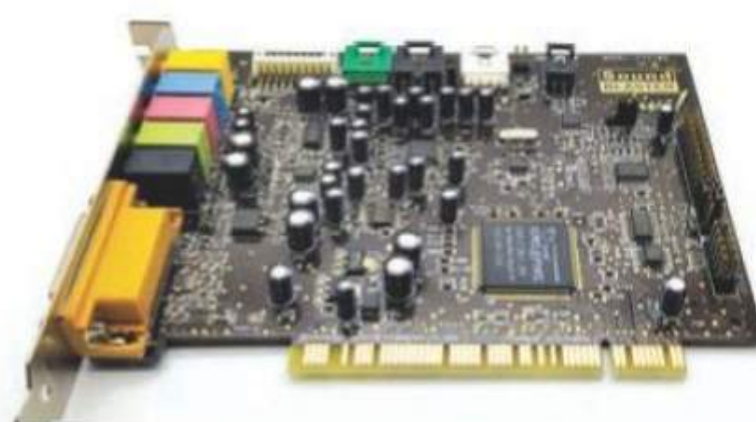
Ajoutez le support de l'EAX et d'un système audio 4.1 à votre machine du précédent millénaire grâce à la Sound Blaster Live!
