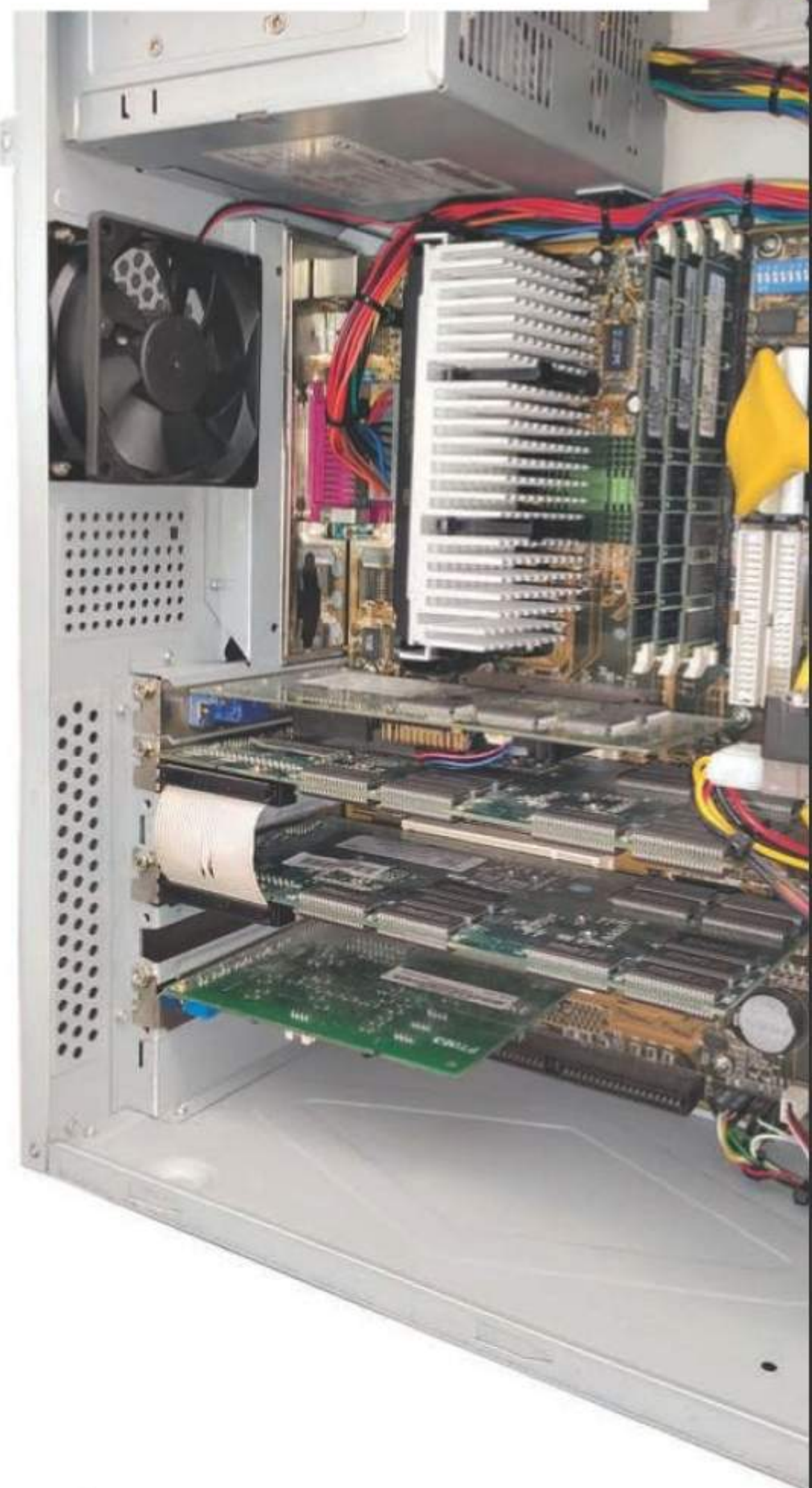
Deux Voodoo 2 en SLI et leur Matrox sur une plateforme 440BX : le système fétiche des amateurs de Glide devient malheureusement inabordable.
