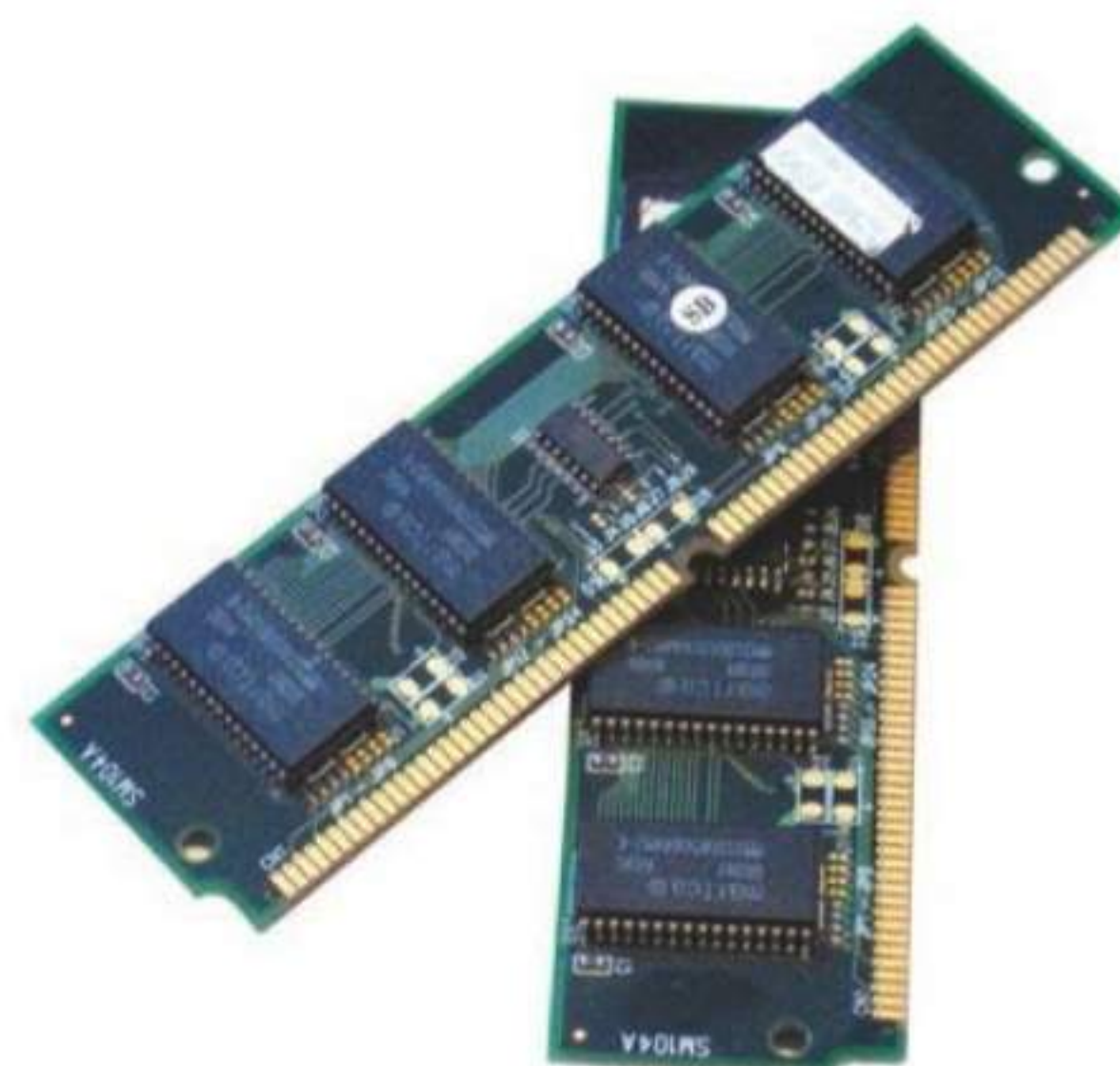
Le bus de données 64 bits de votre Pentium nécessitera de connecter les barrettes au format SIMM par paires.
