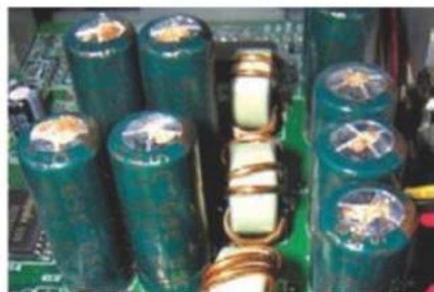
Le condensateur en chinoïsiuim, principal point faible du matériel de l'an 2000.
