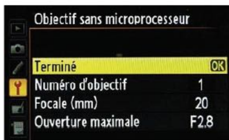
Les anciens objectifs sans microprocesseur peuvent être catalogués pour autoriser notamment la mesure matricielle.
