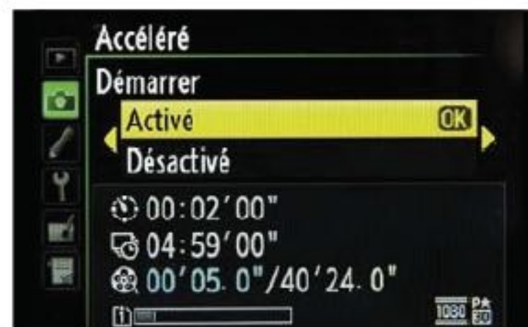
Le menu "Accéléré" permet de compiler une série de photos réalisées à intervalles réguliers dans un fichier vidéo.
