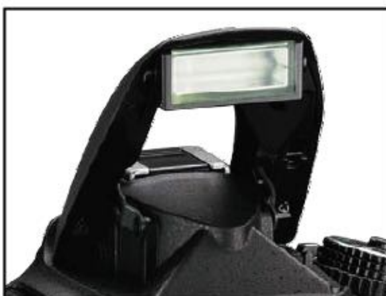
Le flash intégré n'est pas très puissant mais il dépanne et peut piloter d'autres flashes Nikon du système CLS.
