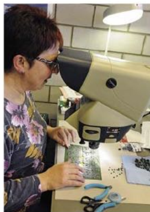
Les composants montés en surface (CMS), assemblés par robot (stepper), sont contrôlés visuellement à la binoculaire.
