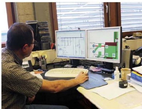
À partir d'un schéma électronique, un technicien crée le circuit tel qu'il sera physiquement implanté. Ce dernier peut présenter plusieurs couches.
