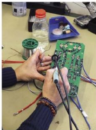
En cas de défaut sur une soudure mécanique ou sur un composant, une retouche manuelle est réalisée sur le champ.
