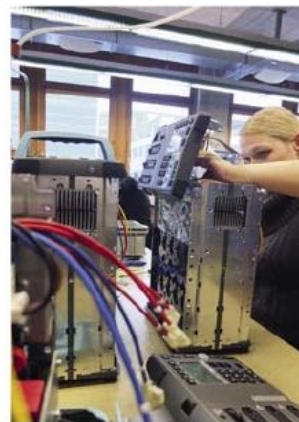
Il faut compter environ 3h30 pour assembler les quelque 1790 pièces qui composent un générateur de type Scoro.
