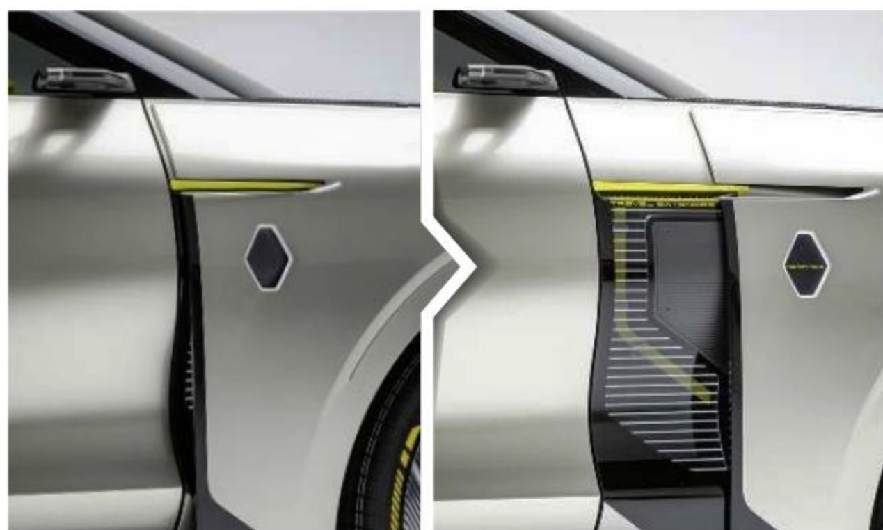
En s'allongeant de 40 cm, dont la moitié vers l'avant, le concept car Morphoz libère l'espace nécessaire à la charge d'une batterie additionnelle, dont on peut suivre le niveau de charge sur le flanc.
