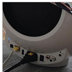
L'Akoya offre une connectivité filaire complète (Ethernet, fibre, RCA, USB).
