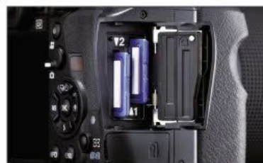
Nouveau chez Pentax, le double slot pour cartes SD offre une souplesse bienvenue. Il est compatible Flucard.
