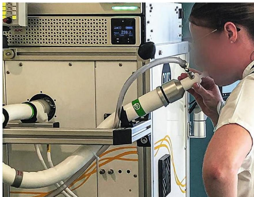
Le Vocus PTR-TOF détecte les molécules du SARS-CoV-2 présentes dans le souffle.
