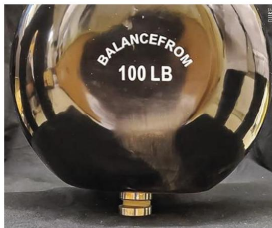
Un disque de 5 mm du cartilage synthétique du genou peut supporter un poids de 45 kg (100 livres).
