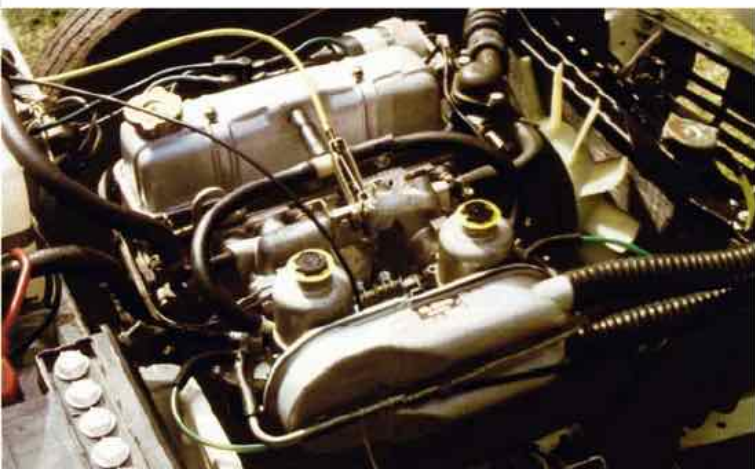
Remis cent fois sur le métier, ce vénérable 4 cylindres 1,5 l à 3 paliers hérite de 2 carburateurs SU. Il développe 72 ch DIN à 5500 tr/mn.
