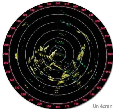
Un écran radar montre la position de navires proches.
