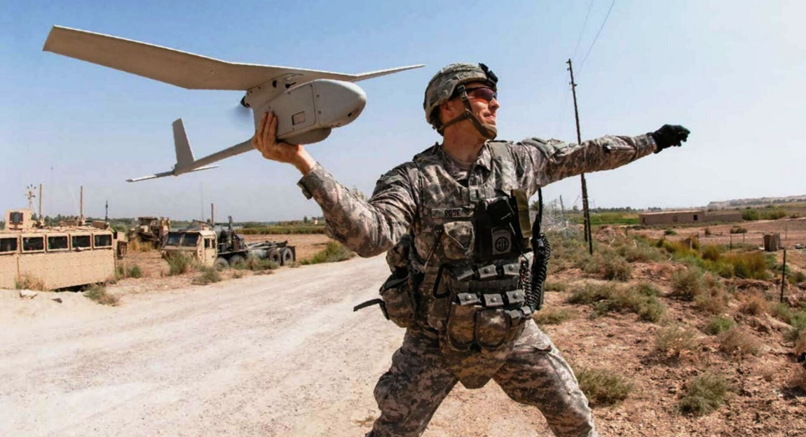
Un drone Raven est lancé d'une base américaine en Irak. Il effectue des missions de surveillance, et s'oriente par GPS.
