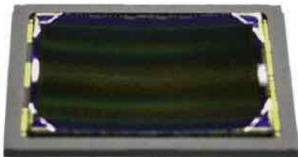
L'un des 2 capteurs CMOS concaves présentés par Sony.
