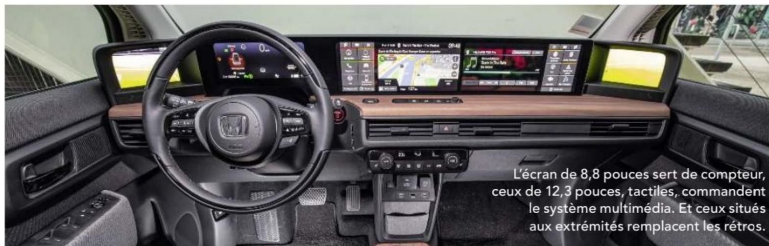
L'écran de 8,8 pouces sert de compteur, ceux de 12,3 pouces, tactiles, commandent le système multimédia. Et ceux situés aux extrémités remplacent les rétros.
