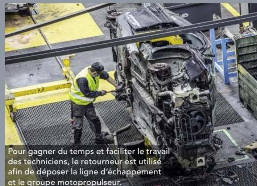
Pour gagner du temps et faciliter le travail des techniciens, le retourneur est utilisé afin de déposer la ligne d'échappement et le groupe motopropulseur.
