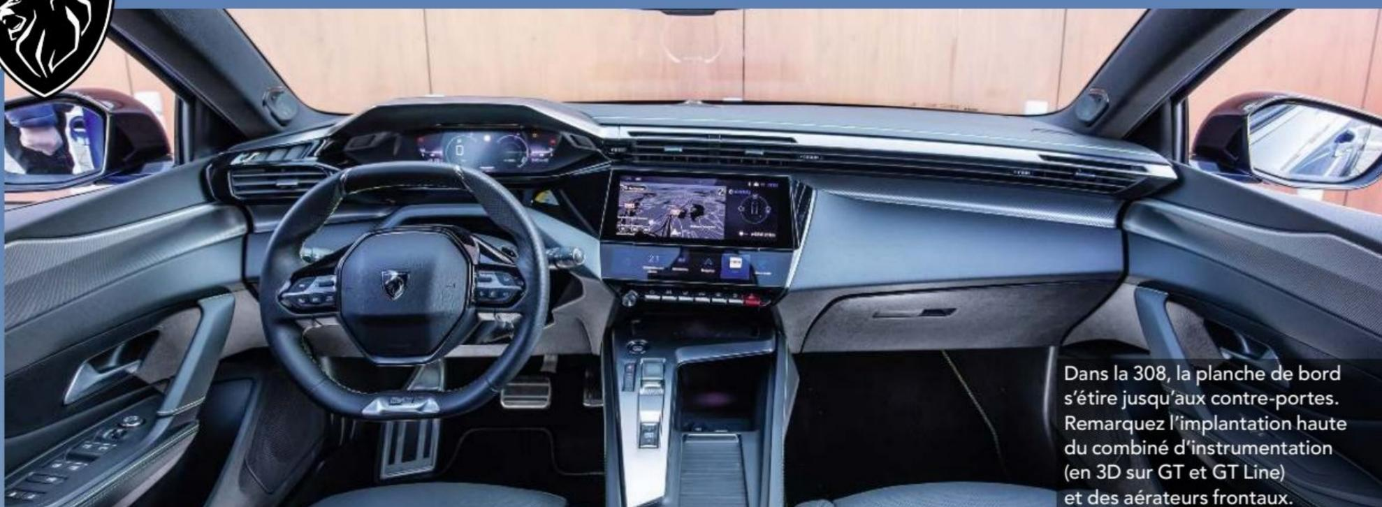
Dans la 308, la planche de bord s'étire jusqu'aux contre-portes. Remarquez l'implantation haute du combiné d'instrumentation (en 3D sur GT et GT Line) et des aérateurs frontaux.
