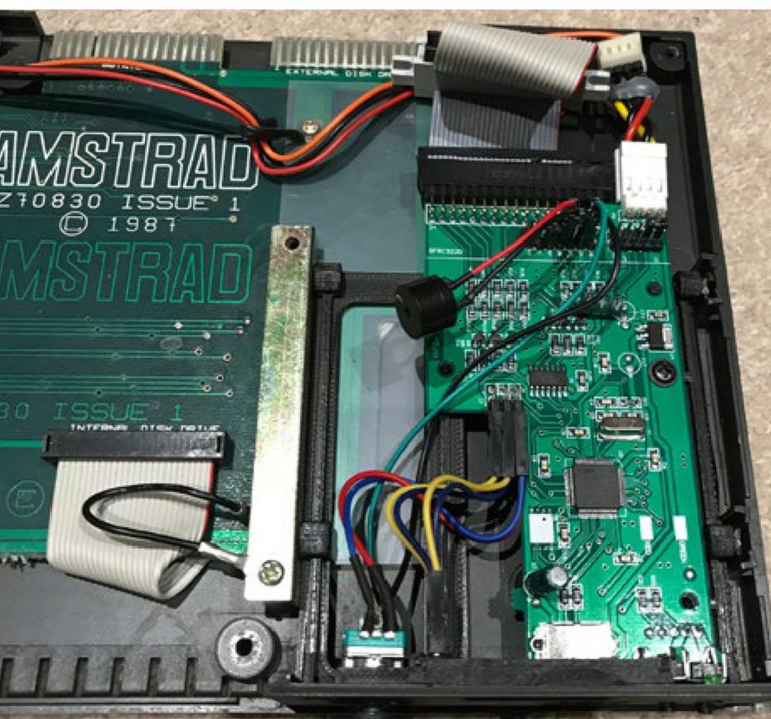
Exemple d'un Gotek installé dans un Amstrad CPC. D'après Tomdalby
