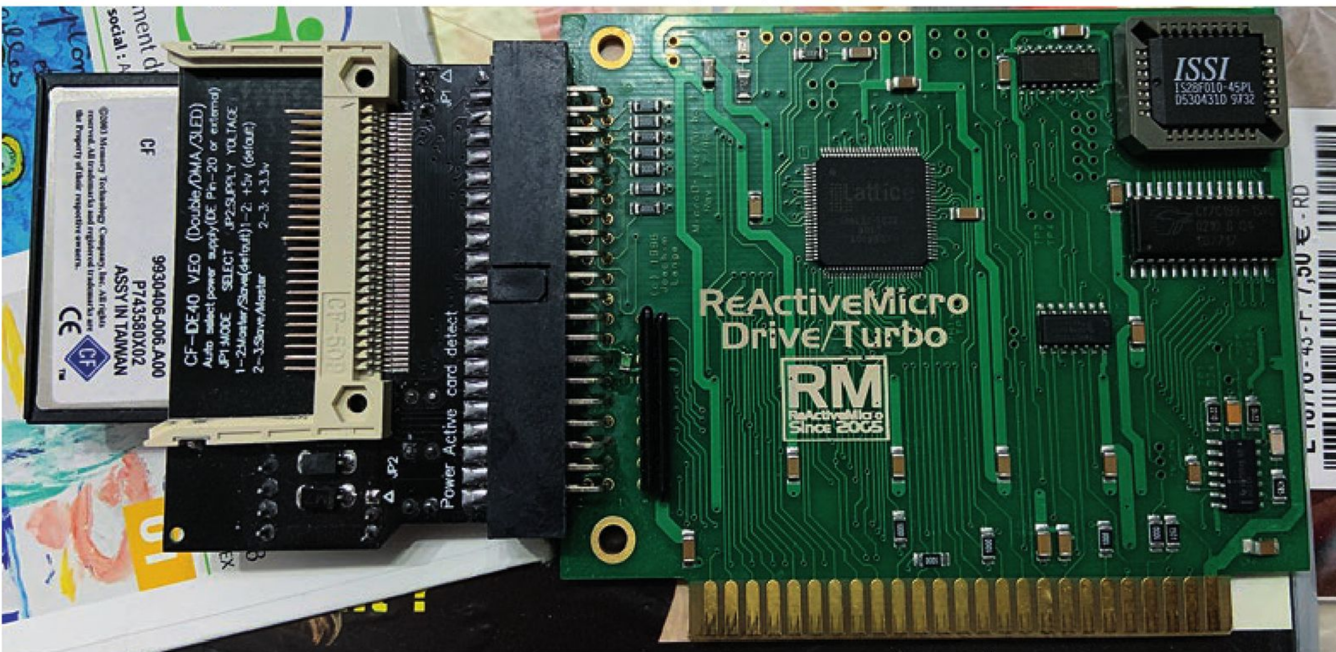
La Micro/Drive est installée dans le slot 7. Ce slot est conseillé.
