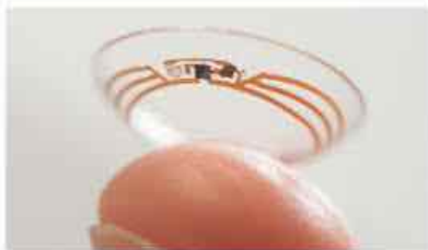
Google vient de présenter un prototype de lentille capable de mesurer le taux de glucose pour les diabétiques.
