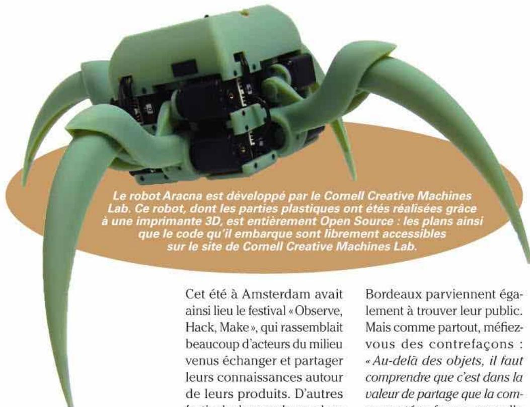
*Le robot Aracna est développé par le Cornell Creative Machines Lab. Ce robot, dont les parties plastiques ont été réalisées grâce à une imprimante 3D, est entièrement Open Source : les plans ainsi que le code qu'il embarque sont librement accessibles sur le site de Cornell Creative Machines Lab.*
