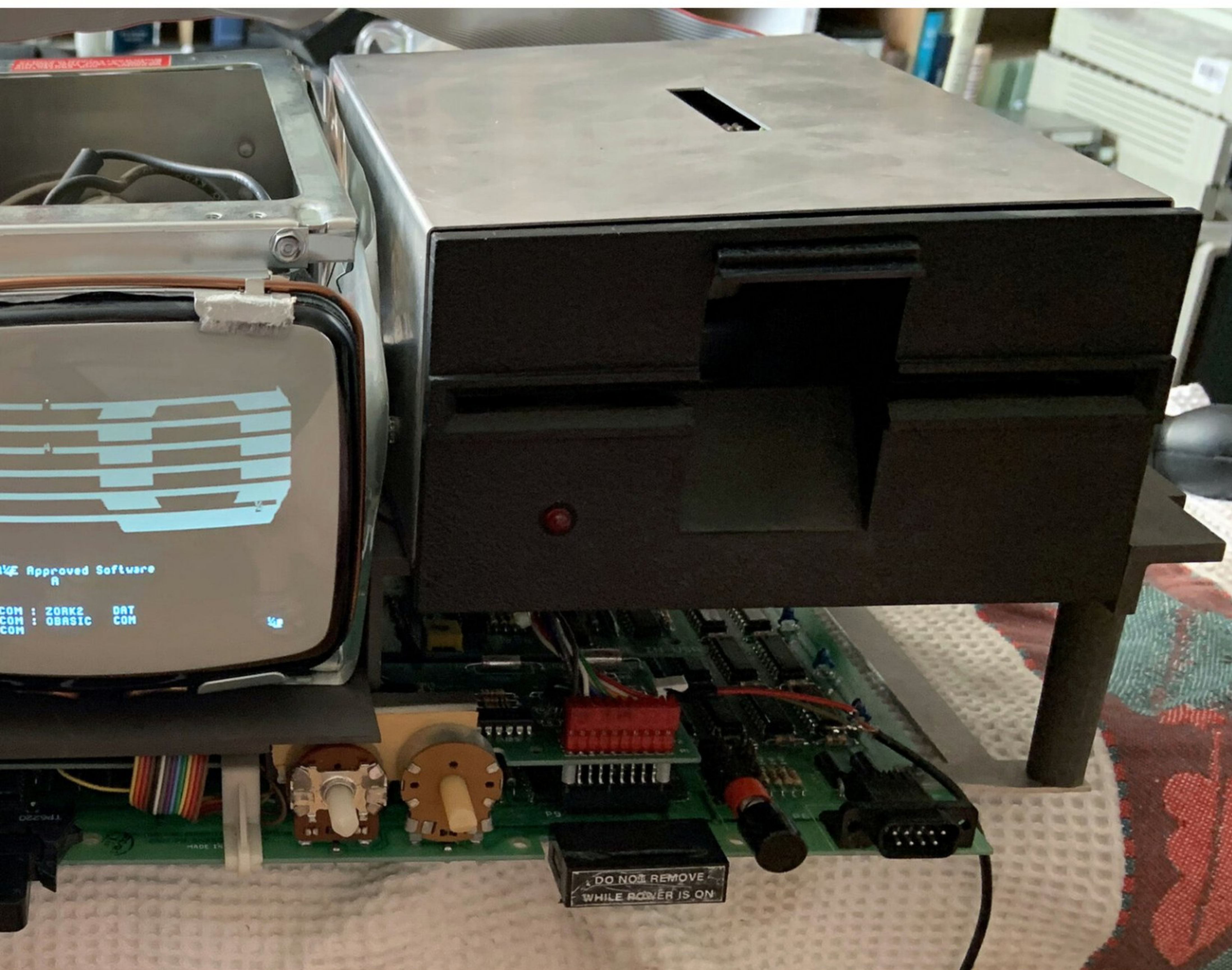
// Osborne 1 en séance de nettoyage. La caisse a été retirée. On voit parfaitement l'ossature supportant l'écran 5" et les deux lecteurs 5 1/4. En dessous, nous avons l'électronique. De gauche à droite : le port modem, le port série, le port IEEE 488, le connecteur clavier, les 2 boutons de réglage de l'écran, le port vidéo externe, le bouton reset et le port batterie. Photo : François Tonic
