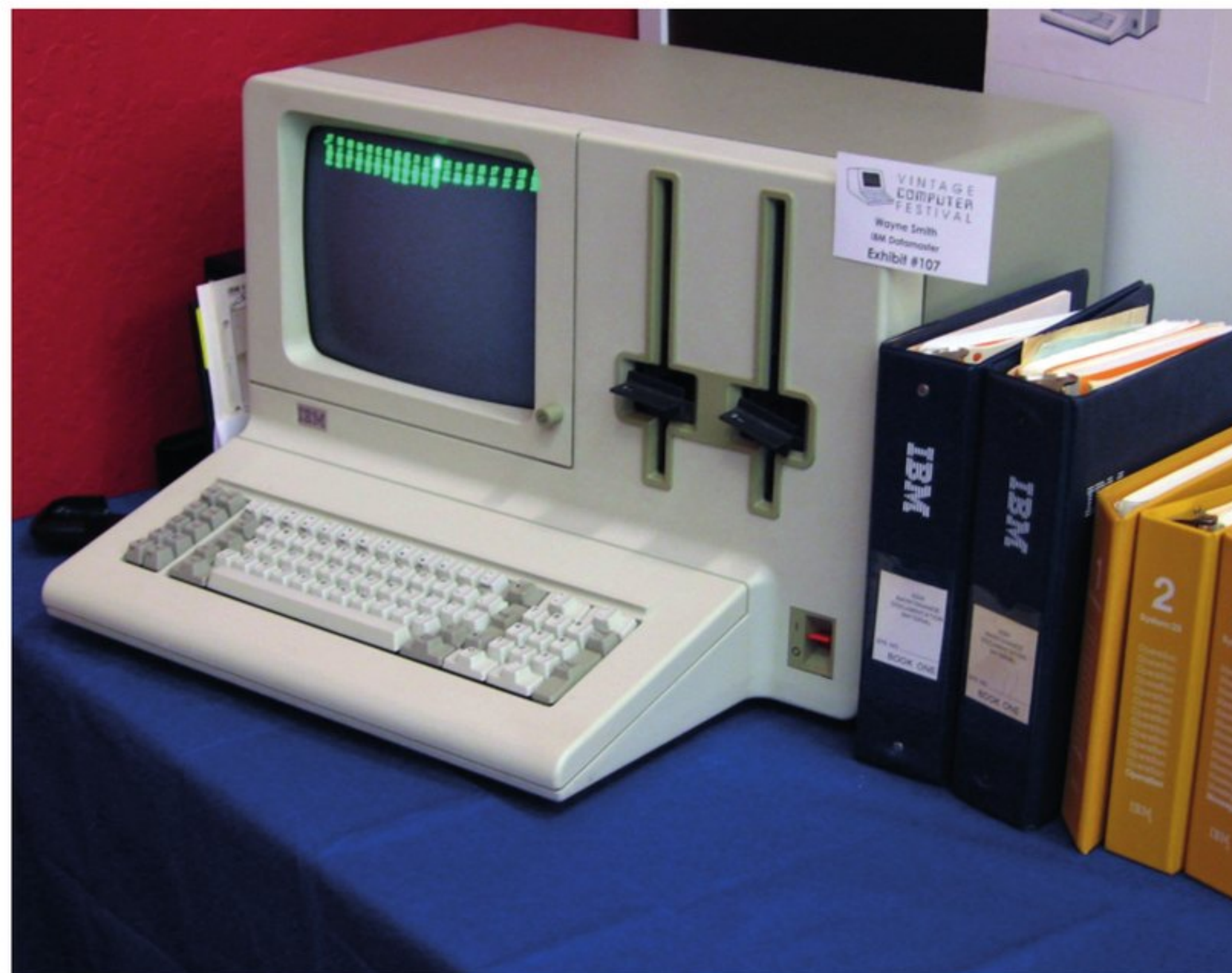
// IBM Datamaster 5322. 42 kg. Plusieurs technologies et matériels du PC viennent de ce monstre. © Marcin Wichary from San Francisco
