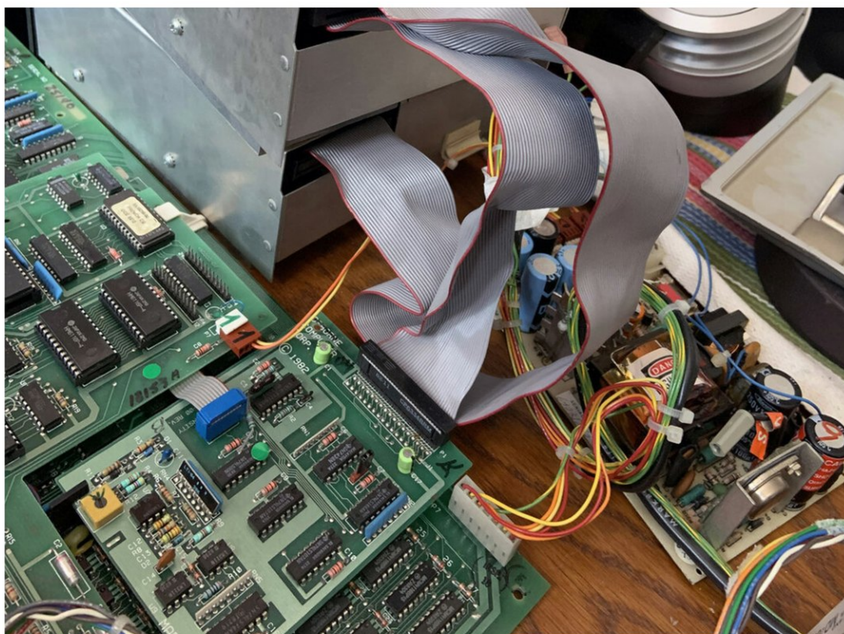
// Osborne 1 en séance de nettoyage. La caisse a été retirée. On voit parfaitement l'ossature supportant l'écran 5" et les deux lecteurs 5 1/4. En dessous, nous avons l'électronique. De gauche à droite : le port modem, le port série, le port IEEE 488, le connecteur clavier, les 2 boutons de réglage de l'écran, le port vidéo externe, le bouton reset et le port batterie. Photo : François Tonic
