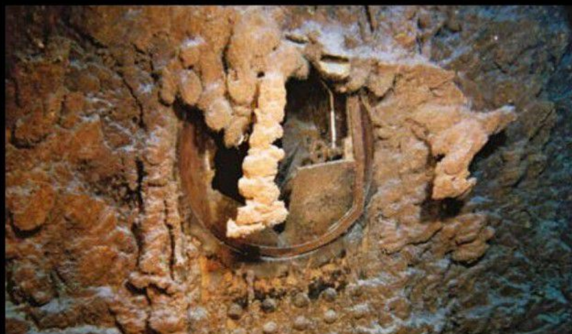
Ci-dessus : les rusticles obstruent un hublot dont il ne reste qu'une partie du verre.
