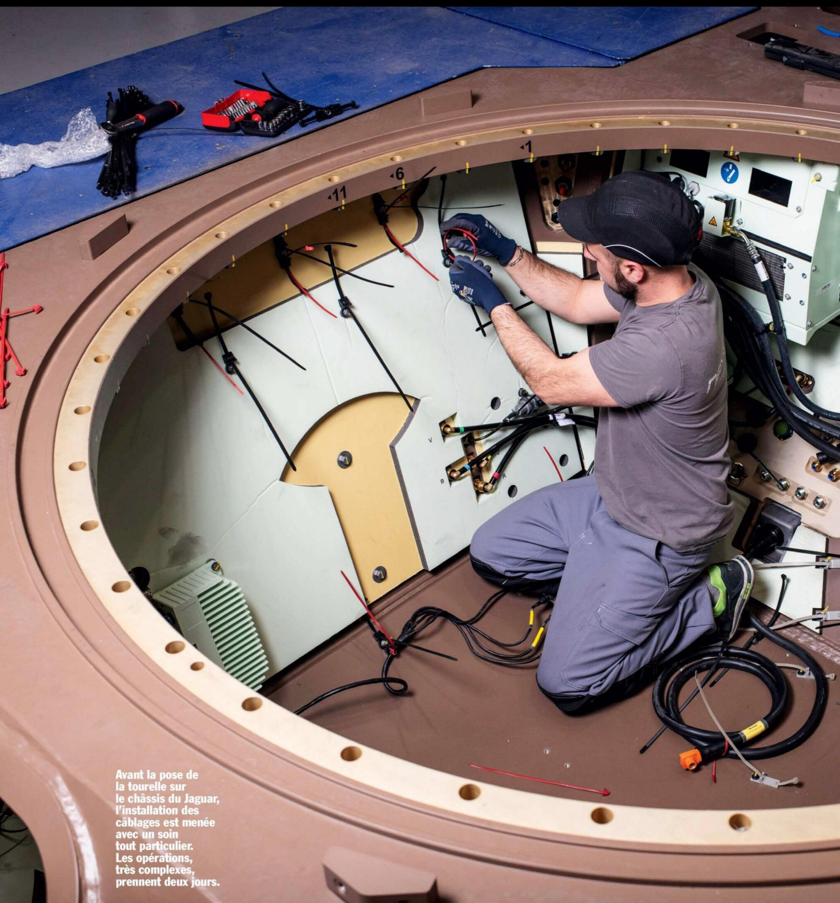
Avant la pose de la tourelle sur le châssis du Jaguar, l'installation des câblages est menée avec un soin tout particulier. Les opérations, très complexes, prennent deux jours.
