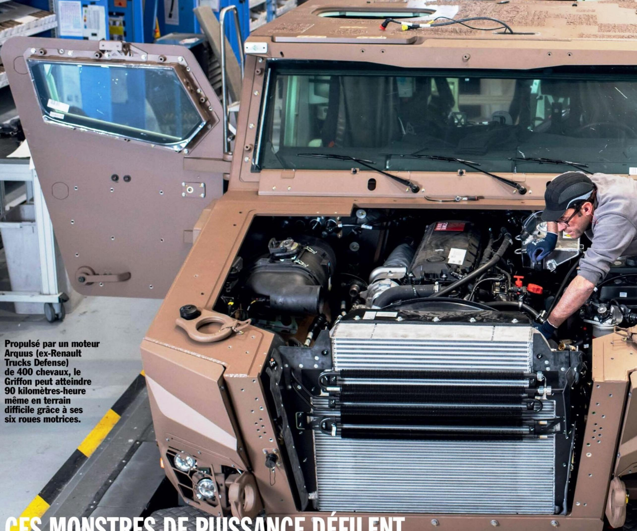
Propulsé par un moteur Arquus (ex-Renault Trucks Defense) de 400 chevaux, le Griffon peut atteindre 90 kilomètres-heure même en terrain difficile grâce à ses six roues motrices.
