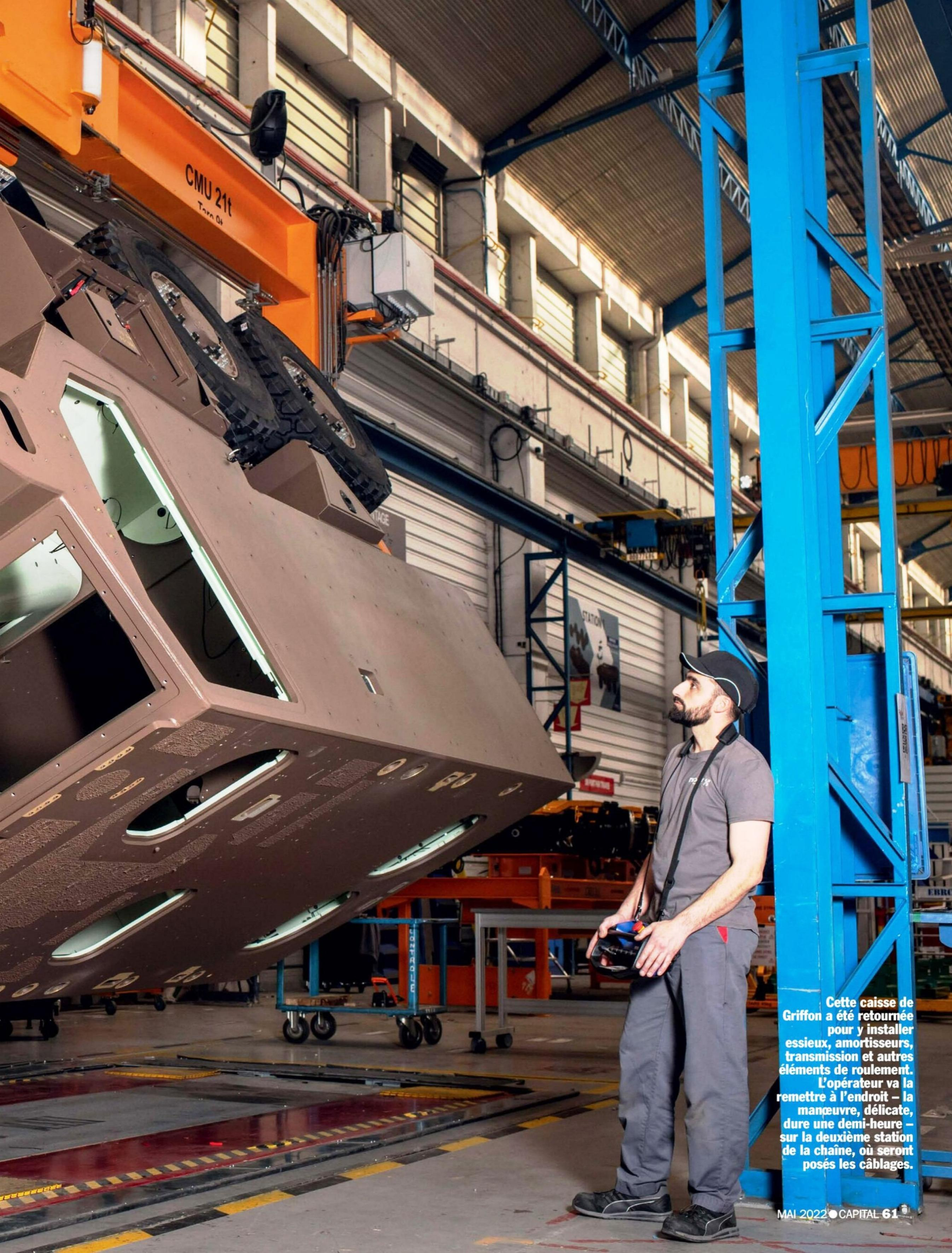
Cette caisse de Griffon a été retournée pour y installer essieux, amortisseurs, transmission et autres éléments de roulement. L'opérateur va la remettre à l'endroit – la manœuvre, délicate, dure une demi-heure – sur la deuxième station de la chaîne, où seront posés les câblages.
