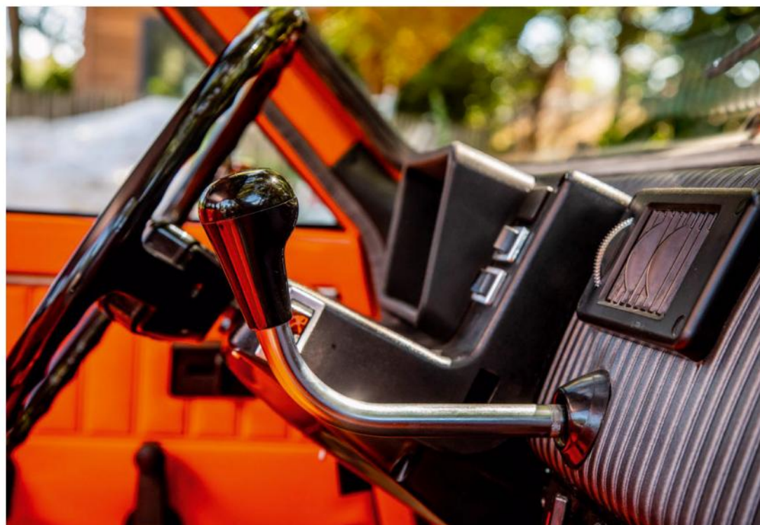
À ses débuts, la R5, conçue sur le châssis de la 4L, en reprend aussi le levier de vitesses au tableau de bord.
