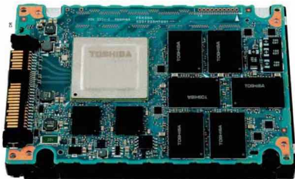
Le SSD d'entreprise PX03SNB160 de Toshiba est optimisé pour des opérations de lecture intensives.
