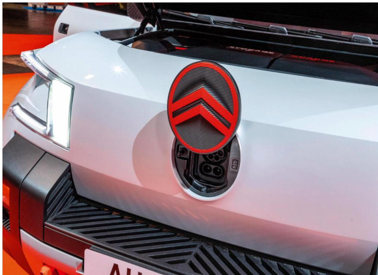
La prise de câble électrique est logée derrière le double chevron "new look" du capot avant.
