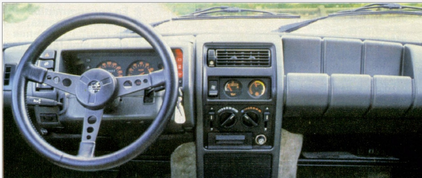
Cette version de la R5 fait des efforts de présentation et ajoute au centre de la console un manomètre de pression du turbo et un manomètre d'huile, en complément d'un joli volant sport à "trou-trous".
