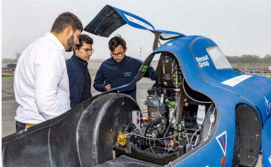
Les étudiants de l'association PV3e ont conçu et fabriqué ce prototype de A à Z, moteur et coque en carbone compris.
