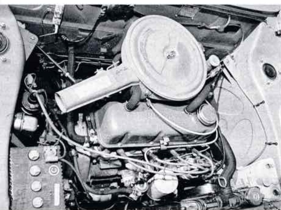
Ce 4 cylindres refroidi par eau, placé transversalement, offre une cylindrée totale de 998 cm<sup>3</sup> et une puissance maxi de 58 ch SAE à 6000 tr/min.
