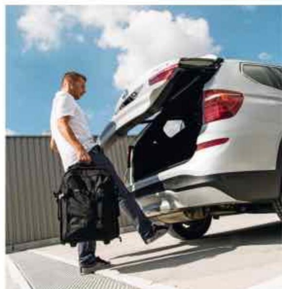
Le hayon électrique est de série. En option, la fonction Smart Opener permet de commander l'ouverture en passant le pied sous le bouclier.
