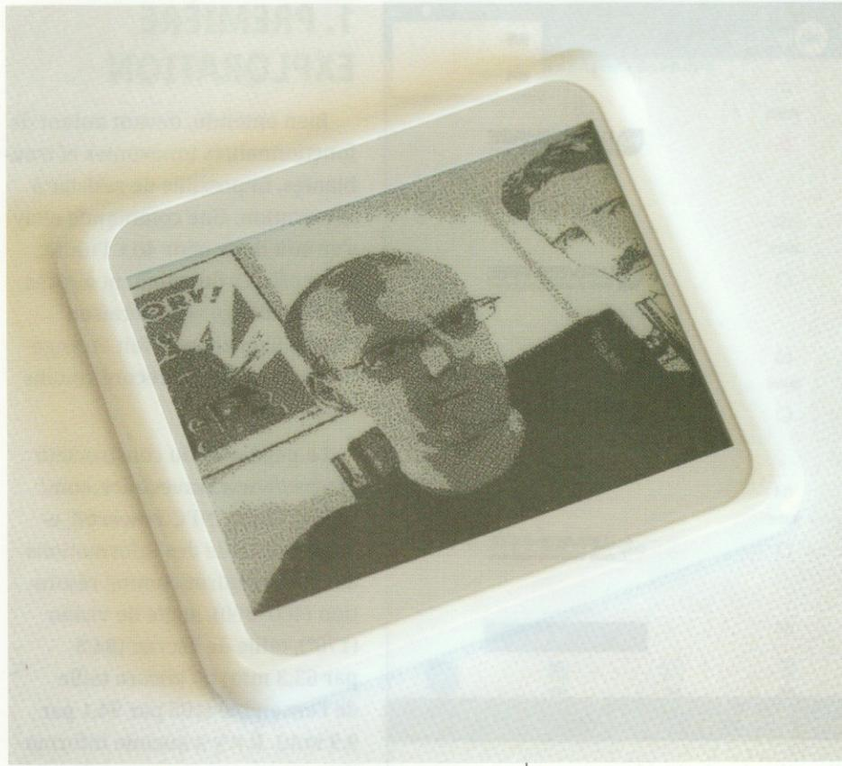
pixels. Ainsi, en plus de la facilité de lecture, plus naturelle, avec ces écrans, ce mode de fonctionnement permet de minimiser les besoins en courant. L'alimentation n'est nécessaire que pour changer l'état des pixels, si rien ne change, l'alimentation est inutile.
