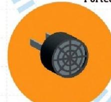
Le capteur à ultrasons repère les objets proches à l'arrière du véhicule et les mouvements.
